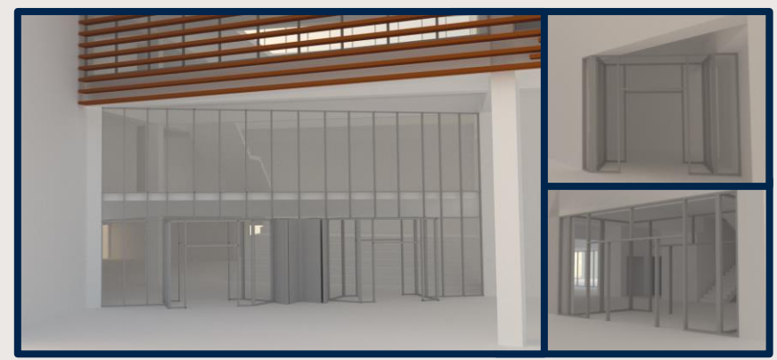
방풍실 설치 : 주출입구
