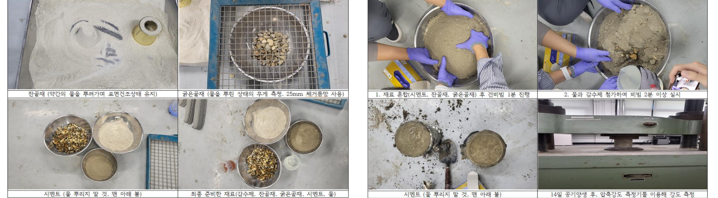
[그림3. 공시체 제작 과정 및 압축강도 측정(UTM 이용)]
